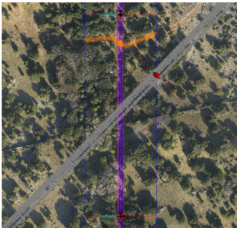
Slika 6: Prikaz modeliranog 35 kV nadzemnog voda na geodetskim podlogama
